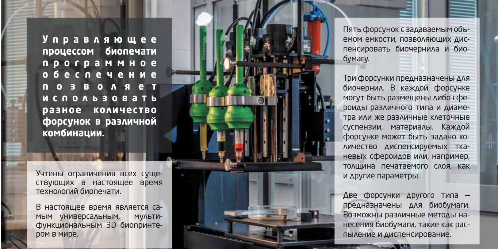
Управляющие процессом биопечати программное обеспечение позволяет использовать разное количество форсунок в различной комбинации.
